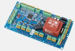
Moduł rozszerzający EM3 do automatyki Genesis 1 (montaż w pompie ciepła)
